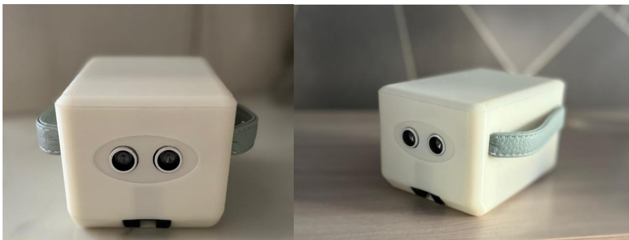
3.4.2-сурет. Көру қабілеті нашар адамдарға арналған құрылғының дайын макеті
